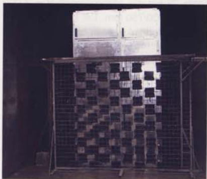
Abb. 3. Prüfanordnung der zwei (neu nach IEC 62271-200) Schaltfelder
