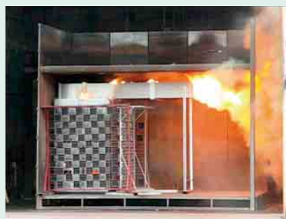
4 Prüfaufbau der Schaltfelder mit einem Druckentlastungskanal oben Offene Türen zeigen Innenausbau
