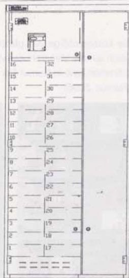
Abb. 3. Schaltfeld mit 32 Schubeinsätzen der Größe 4E/2 (MiNiS Systeme GmbH)
