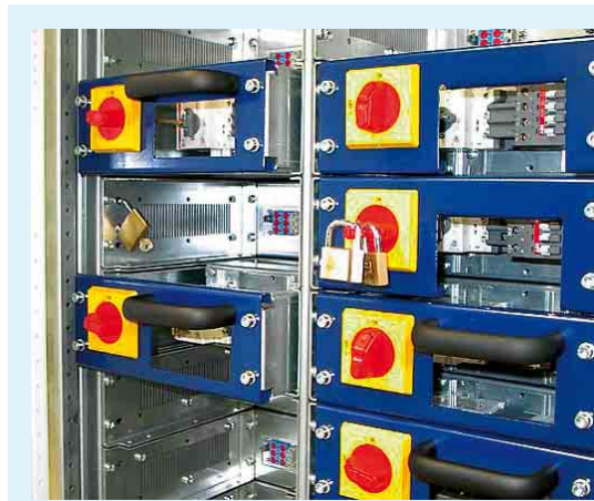
3 Schubeinsatz-Technik der 3. Generation mit verschiedenen Positionen der Schubeinsätze Rechts: Betriebs- und Prüfstellung Links: Trenn- und Absetzstellung
