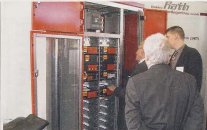
Muster-Schaltfeld der Firma MiNiS + Systeme GmbH (MoNA 5000) mit unterschiedlicher Bestückung der Modulgrößen 4E/2 und 8E/2. Stand der Fa. Elektro-Rath Schaltanlagenbau GmbH auf der Elektrotechnik in Dortmund letzten Herbst
